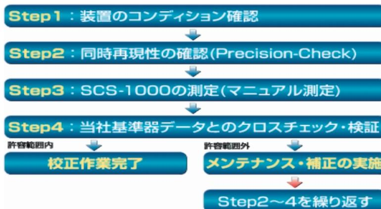
図3. 校正作業のフロー
