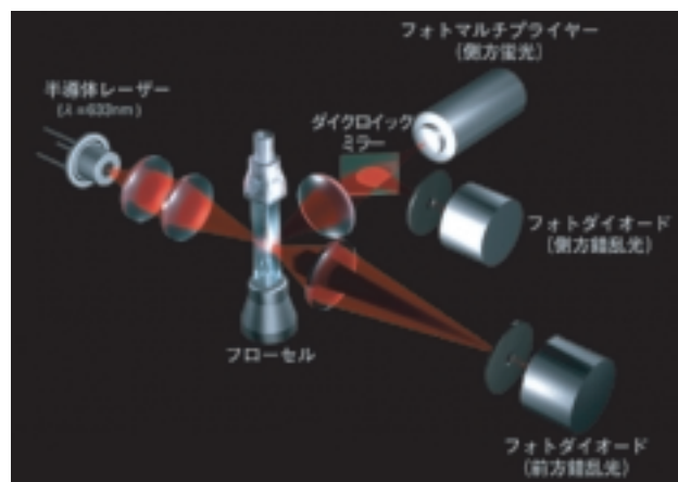
図2. 半導体レーザーを用いたフローサイトメトリー
