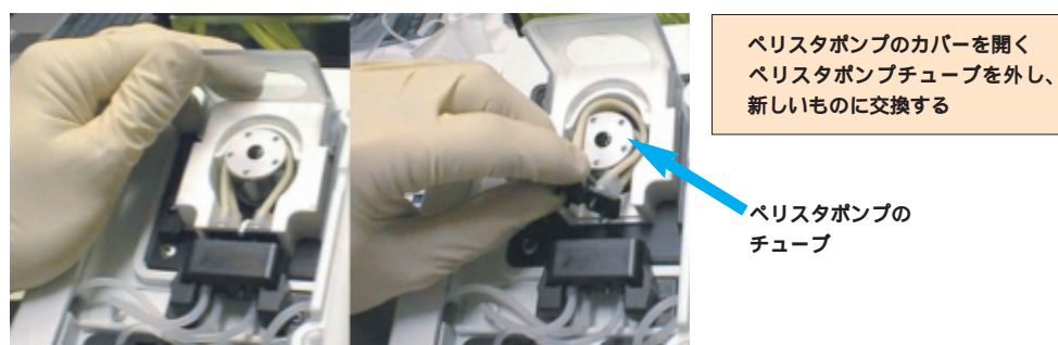
図7 . ペリスタポンプのチューブの交換
