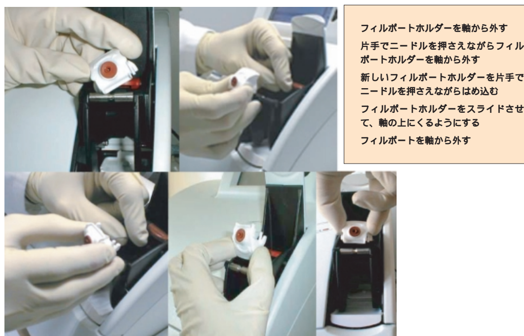
図8 . フィルポートホルダーの交換
