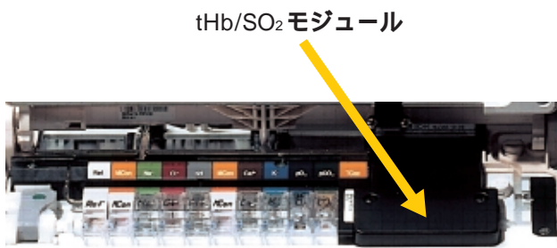
図3 . 測定チャンバ内のtHb/SO 2 モジュール
