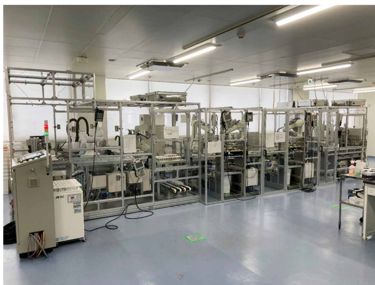
図 7. 自動 PCR 検査ロボットシステム 全体
