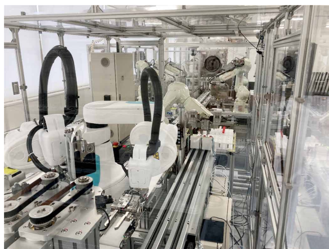
図8. 自動 PCR 検査ロボットシステム 開栓分注ユニット
