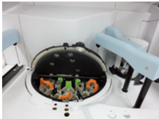
図 2. CS シリーズにおける血小板凝集能の測定（サンプルチューブ SB・試薬の準備）
