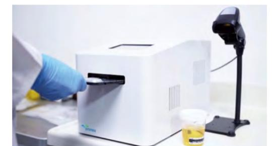
薬剤感受性検査システムの機器および試薬カートリッジ
