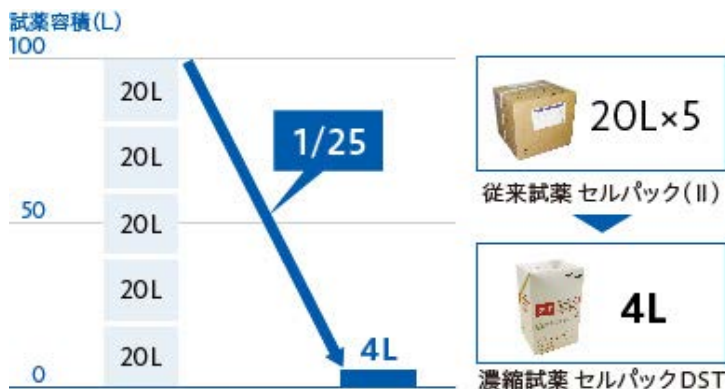
XNシリーズの試薬は従来試薬の25倍濃縮試薬
