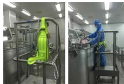
左：作業時に装着する安全帯 右：安全帯を装着してタンクに材料を投入
