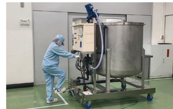
からくり改善くふう展で協会特別賞を受賞した「お助けペダル」(てこの原理により、試薬調製用移動式1トンタンクを運搬する際の初動を楽にするための治具)
