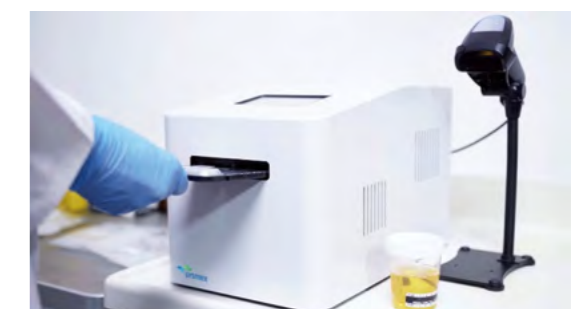
薬剤感受性検査システムの機器および試薬カートリッジ
