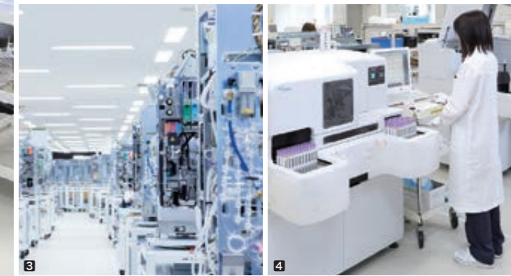
1 生産エリアの様子。仕切りのないオープンな環境です。2 見学コースからも生産エリアを一望できます。3 当社のフラッグシップモデルである「XNシリーズ」をはじめ、高機能モデルを中心に生産しています。4 全自動血液凝固測定装置の生産ライン。このような大型の機器の生産にも耐えられるよう、床の耐荷重は500kg/m 2 あります。
